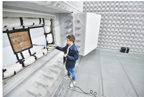
4月26日，中国汽研NVH技术中心全消声室，工程师正在测试隔音材料的隔音性能。
