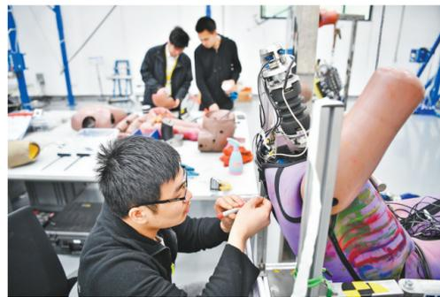
4月26日，中国汽研碰撞试验假人标定实验室，工程师正在反复对假人进行调试和校准。
