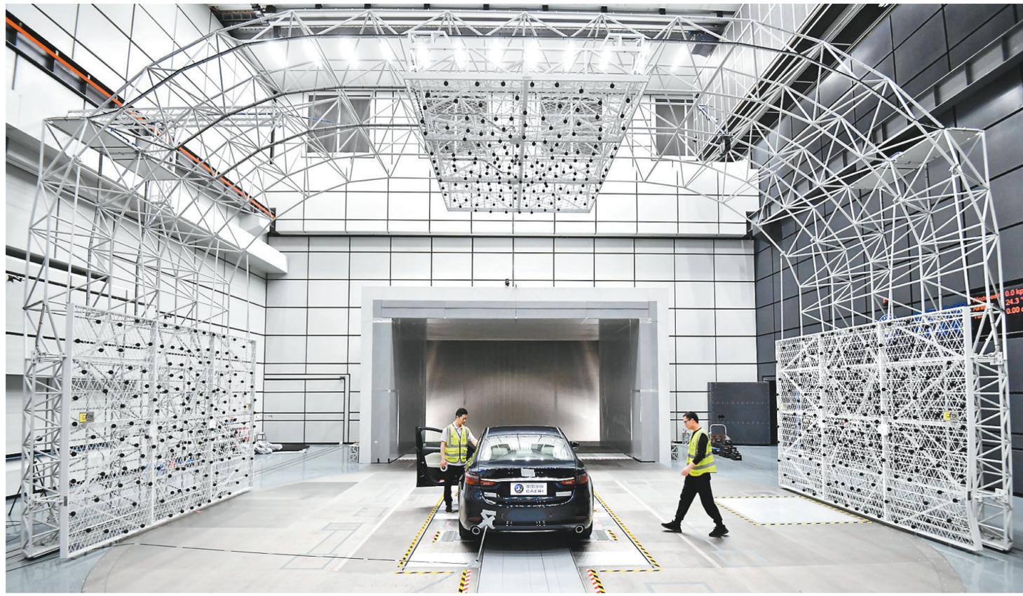
四月二十六日，中国汽研汽车风洞中心，麦克风阵列系统由左侧、右侧和顶部三块阵列组成，总共五百零四个麦克风。
