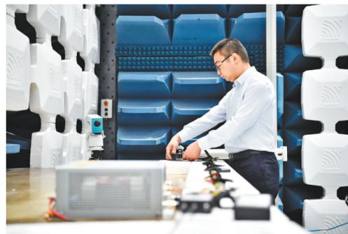
4月26日，中国汽研EMC实验室，工程师正在测试验证手机电磁波是否会影响车辆零部件正常工作。
