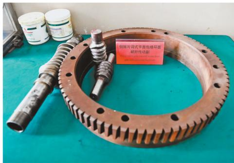
▲4月28日,重庆大学机械传动国家重点实验室,展示的侧隙可调式平面包络环面蜗杆传动副。
