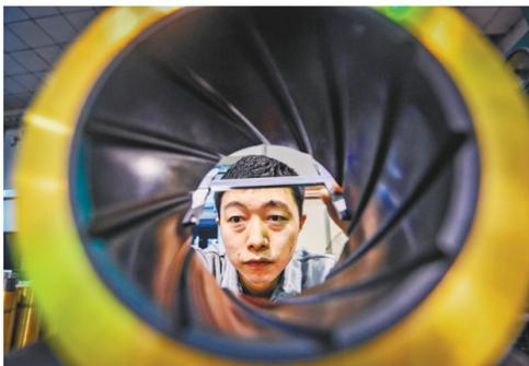
▲4月28日,重庆大学机械传动国家重点实验室,技术人员正在测量不同型号的水润滑轴承。该材料具有较好的自滑性和优良的抗磨擦性。
