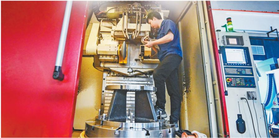
▲四月二十八日,重庆大学机械传动国家重点实验室,关键零部件研制中心,技术人员正在安装齿轮进行加工。
