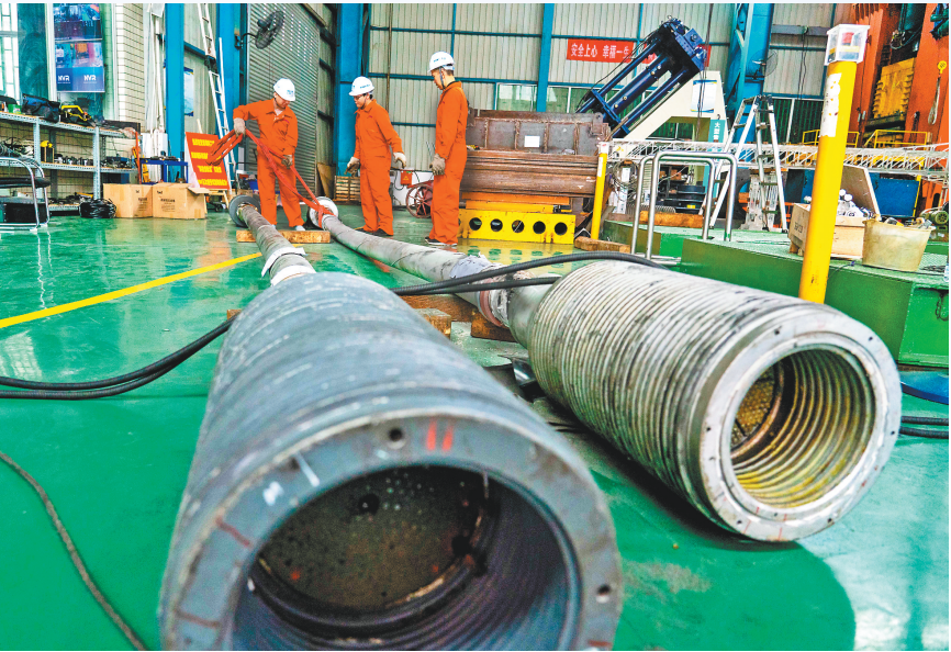
4月26日,桥梁工程结构动力学国家重点实验室内,技术人员正在准备为桥梁工程索缆做拉弯疲劳试验。
