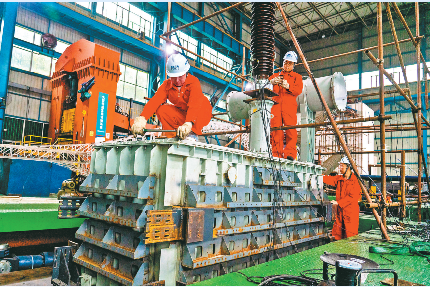
4月26日,桥梁工程结构动力学国家重点实验室内,技术人员正在大型地震模拟试验台上调试实验设备。
