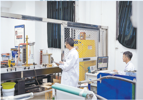
4月27日，输配电装备及系统与新技术国家重点实验室，技术人员正在进行高电压冲击试验。
