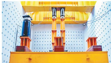
山区桥梁及隧道工程国家重点实验室的隧道实验楼内，隧道及地下结构三维模型试验系统。
