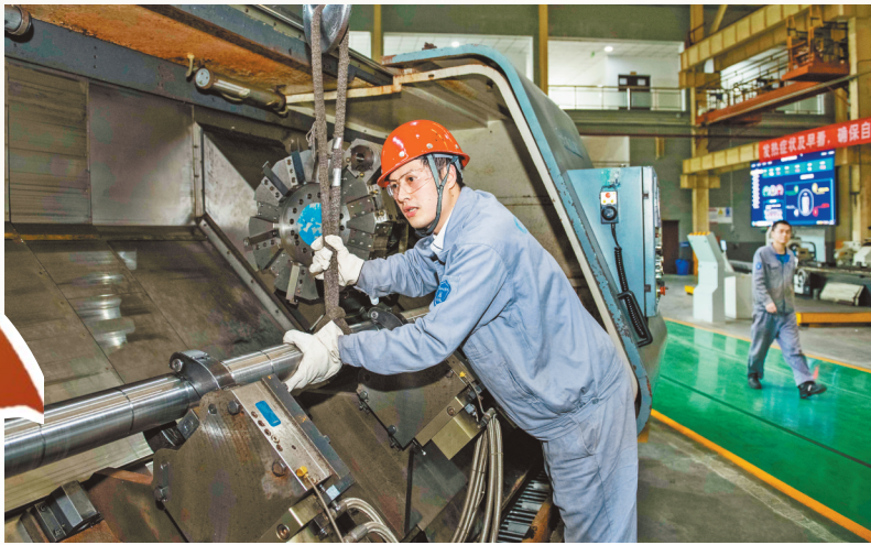
▲4月27日，重庆水泵厂有限责任公司机加中心，数控车工朱举华正准备用数控机床加工离心泵的轴。朱举华专注技术创新，每年为企业节约成本数百万元，还为行业复杂零件加工提供了技术支持。 记者 张锦辉 摄/视觉重庆
