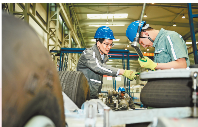
▲4月28日，重庆轨道集团童家院子基地，黄德勇(左一)在检查列车的零部件磨损程度。黄德勇潜心单轨技术攻关，助力重庆跨座式单轨技术逐渐迈入世界先进行列。 首席记者 龙帆 摄/视觉重庆
