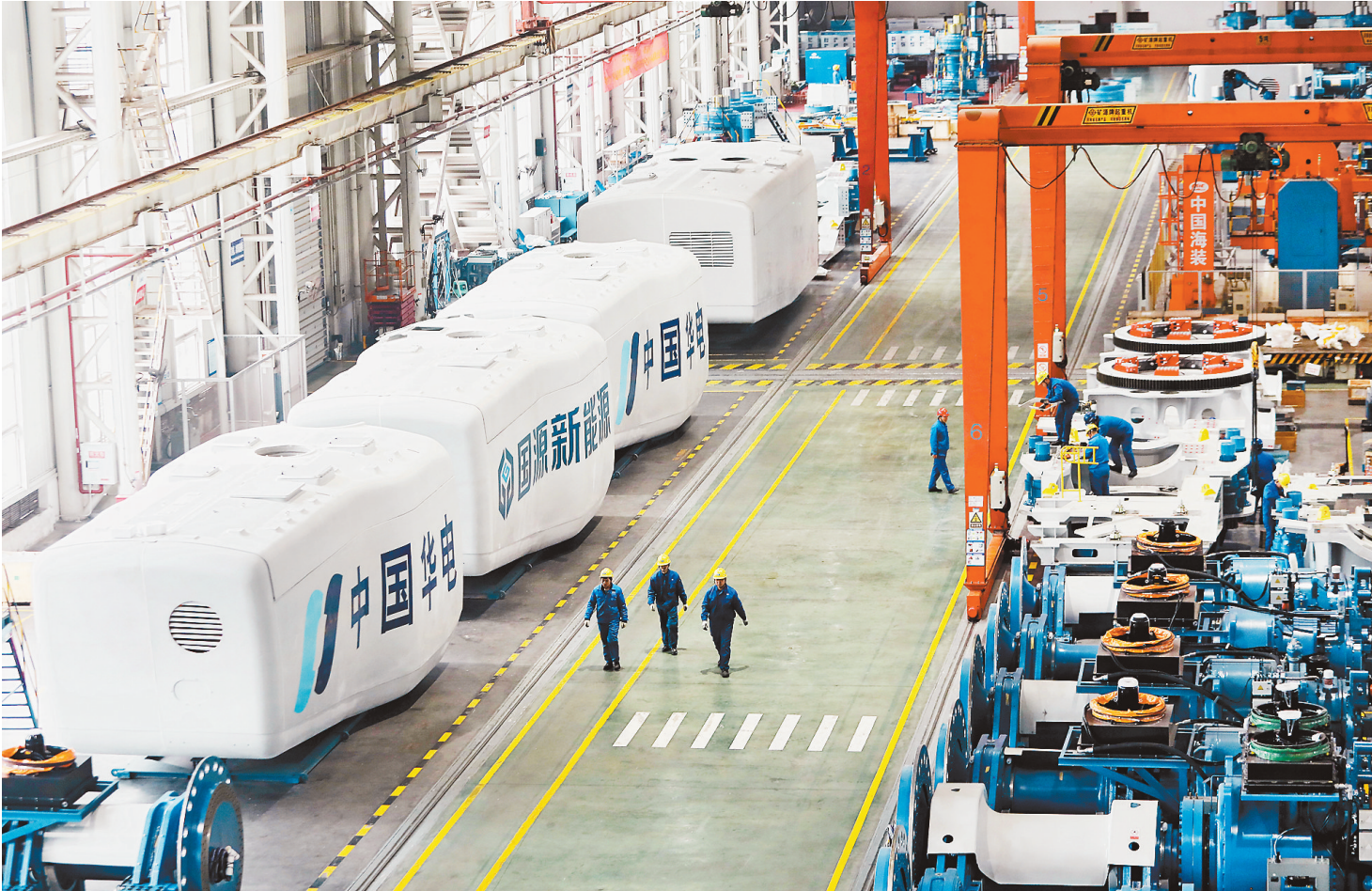
图片 二〇二一年一月八日,中国海装厂房内,技术人员正在紧张装配风电机组。(本报资料记者 罗斌 摄/视觉重庆)
