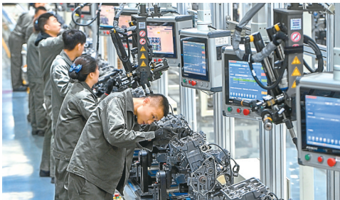
隆鑫通用C区工厂，工人正在生产线上组装KE500发动机。
