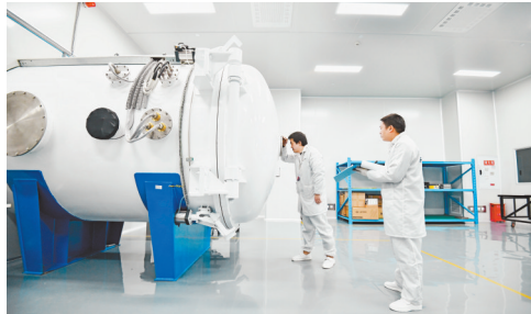
3月23日,重庆开拓卫星科技有限公司,工作人员正在进行太阳电池阵热真空实验。 记者 谢智强 摄/视觉重庆
