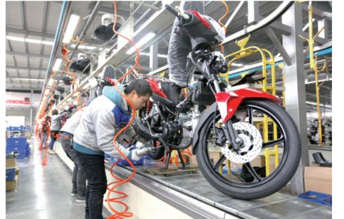
重庆大隆宇丰摩托车制造有限公司整车组装线
