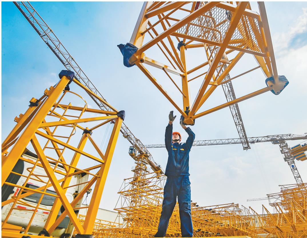
▲3月5日,重庆高新区,徐工塔机重庆公司,工人正在吊装塔机标准节。该公司主要生产塔式起重机,产品广泛运用于房地产建设、公共工程、桥梁建设、水利电力、港口建设等领域。今年1-2月,该公司销售收入1.45亿元,较去年同期增长119.70%,预计全年销售收入超15亿元。 首席记者 龙帆 摄/视觉重庆
