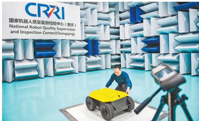
2月23日,在国家机器人检测与评定中心(重庆),测试工程师在半消音室运用声级计评价一运输机器人的噪音值。
