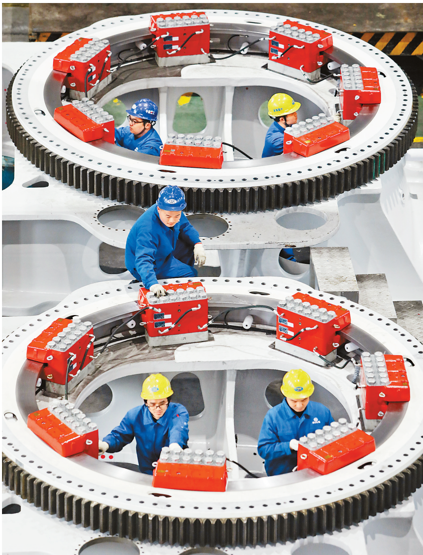
1月8日，位于两江新区礼嘉的中国船舶集团海装风电股份有限公司厂房内，技术人员正在抓紧装配风电机组。 记者 罗斌 摄/视觉重庆
