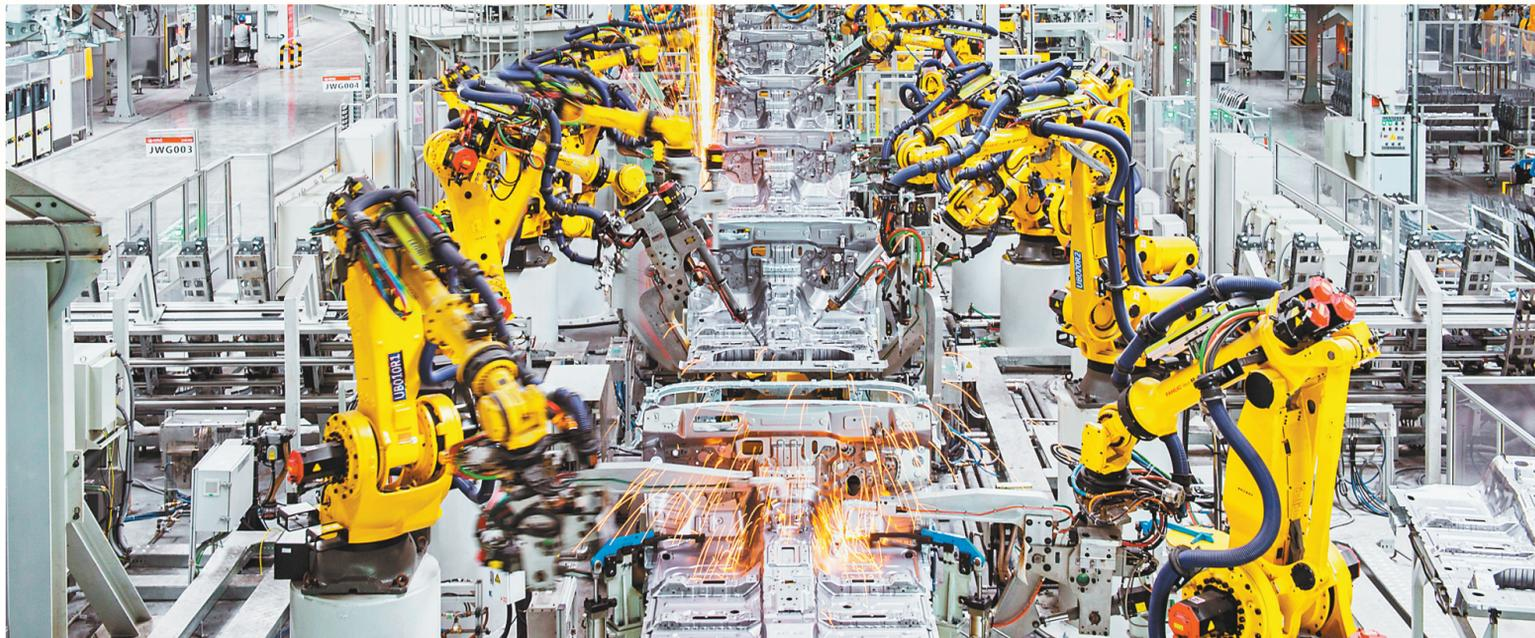
长城汽车永川工厂,焊装车间生产线上的全自动机器人正在工作。首席记者 崔力 摄(视觉重庆)
