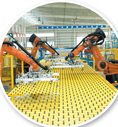
万盛浮法玻璃自动化生产线
