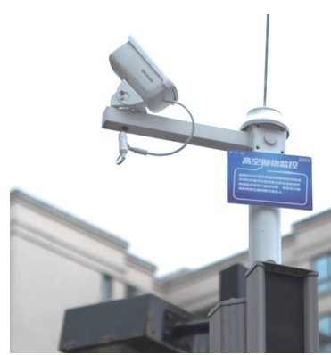
平安小区内布设基于中国移动5G网络的高空抛物监控设备
