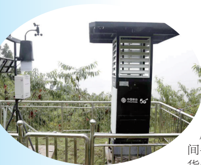
中国移动重庆公司利用物联网技术打造的微型气象站，实时监测果园情况
