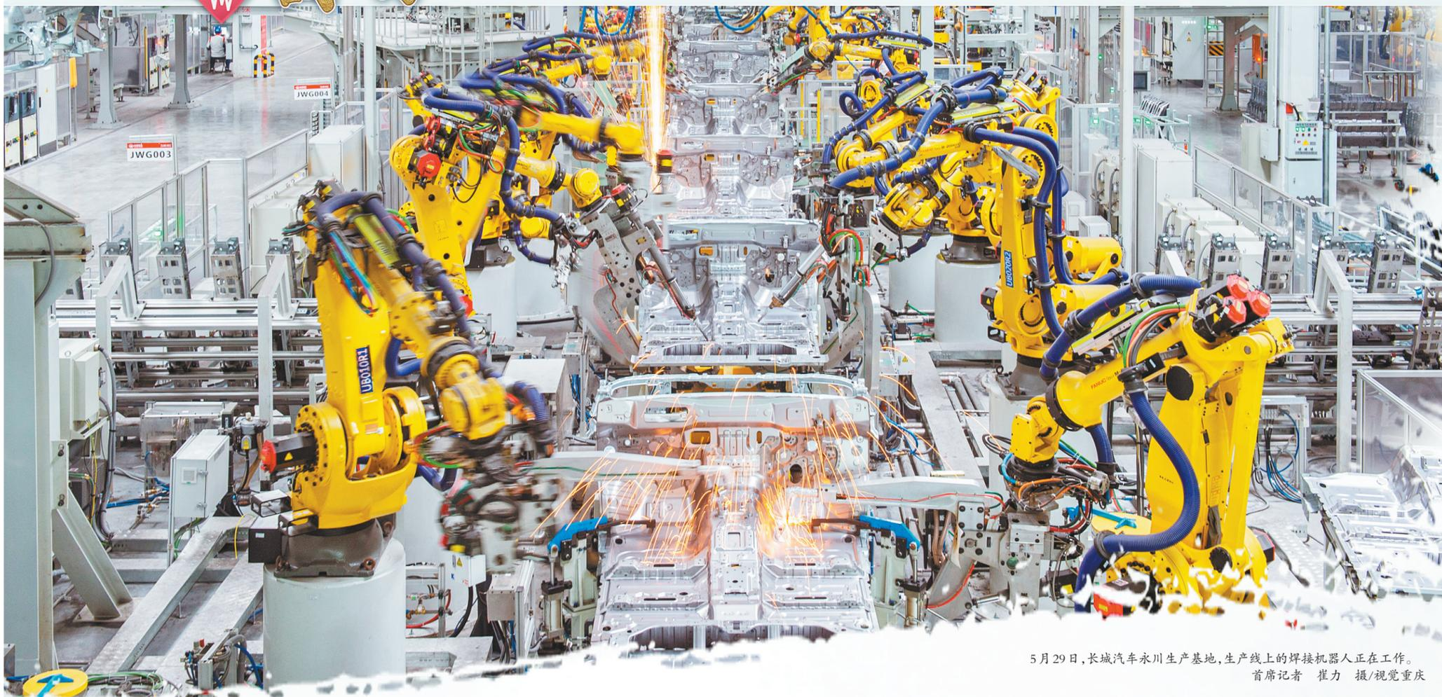
5月29日,长城汽车永川生产基地,生产线上的焊接机器人正在工作。 首席记者 崔力 摄/视觉重庆
