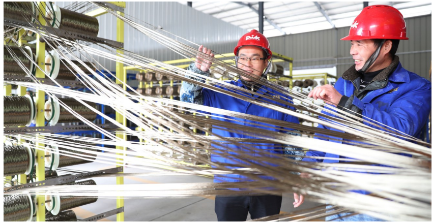
四川帕沃可矿物纤维制品有限公司的工人在检测用玄武岩为原材料生产的纤维复合筋
