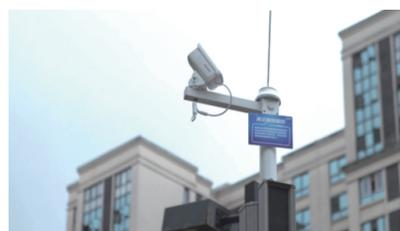
平安小区内布设基于中国移动5G网络的高空抛物监控设备
