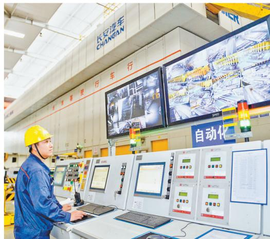
2019年10月24日,长安汽车两江基地乘用车工厂冲压车间,工人通过中控台监控封闭式高速智能冲压生产线。
