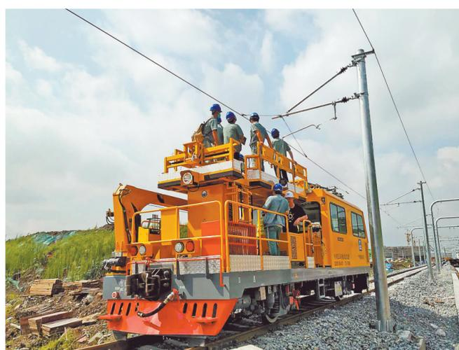
九号线一期接触网作业车进行冷滑试验。(中建五局安装公司供图)
