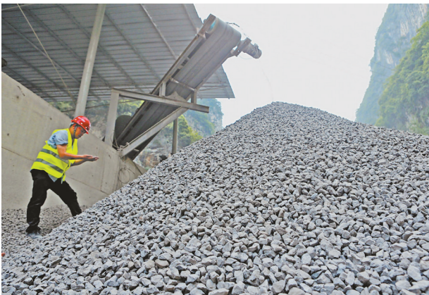
▲城开高速精品砂石料加工厂,中铁十一局集团将隧道内挖出的岩石打碎,“变废为宝”成为桥梁浇筑的原料。不仅降低成本,还能更好地保护环境。
