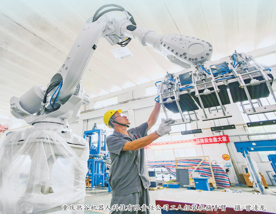
重庆康佳机器人研发创新中心工人组装机器人臂 摄/曾清龙
