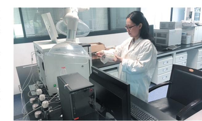
代沁芸在实验室开展废气非甲烷总烃测定试验
