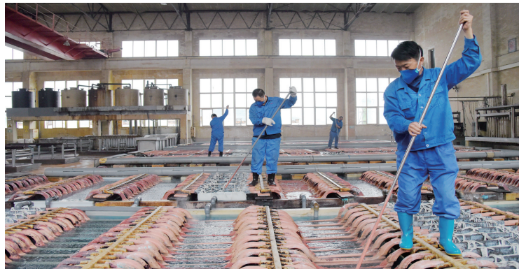
位于綦江区三江街道的重庆有研重冶新材料有限公司，工人正在刮电解铜粉 摄/覃宁波
