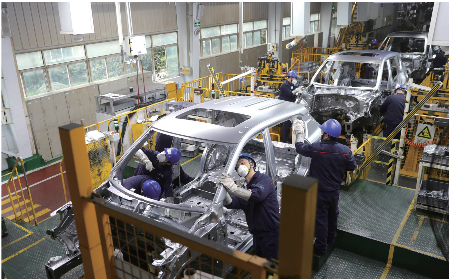
空港工业园区的长安汽车渝北工厂内,员工在焊接车间打磨车身
