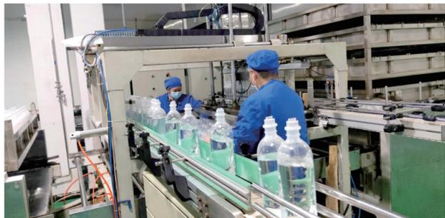
天圣制药大容量注射液塑料瓶灌装生产线 摄/陈睿华
