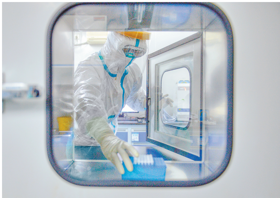
▲2月14日，在沙坪坝区疾控中心二级生物实验室，检测人员肖小月将扩增管通过单向传递窗提取到核酸扩增室。
