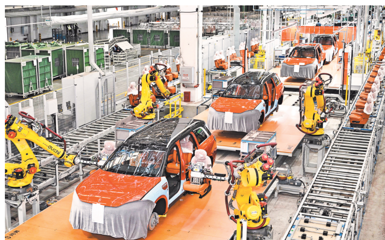
位于两江新区龙盛新城的赛力斯汽车超级工厂，机器手臂正在安装座椅。（资料图片） 记者 张锦辉 摄影 视觉重庆
