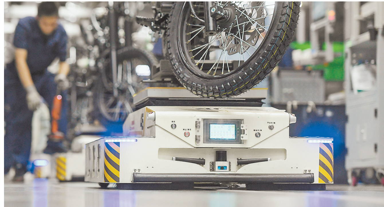
位于巴南区的重庆宗申机车工业制造有限公司,高端摩托车生产车间的AGV小车搭载着摩托车架在各个工位上移动(资料图) 记者 张锦辉 摄视觉重庆
