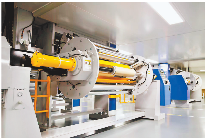
江苏厚生重庆基地无尘生产车间里，智能化生产锂电池隔膜。 通讯员 李慧敏 摄视觉重庆
