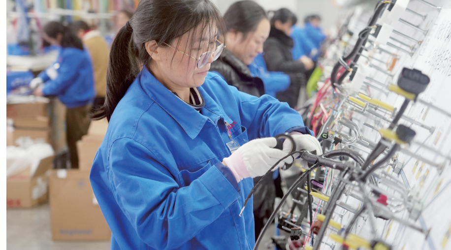
重庆乐仁汽车电子有限公司实现数字化转型,生产车间工人给汽车线束打结 摄/向成国
