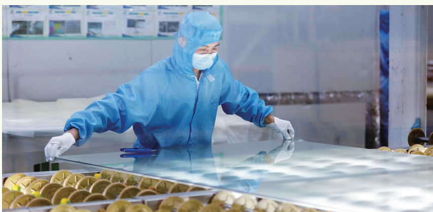
耀皮工程玻璃有限公司无尘车间,工人在对玻璃进行夹胶工艺处理 摄/王泸州
