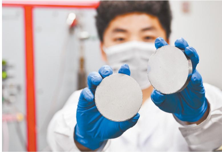
三月二十四日，国家镁合金材料工程研究中心，研究人员展示单块重九十克的“固态储氢粉饼”，可储存约四点五克氢气。 记者 张锦辉 摄影 视觉重庆
