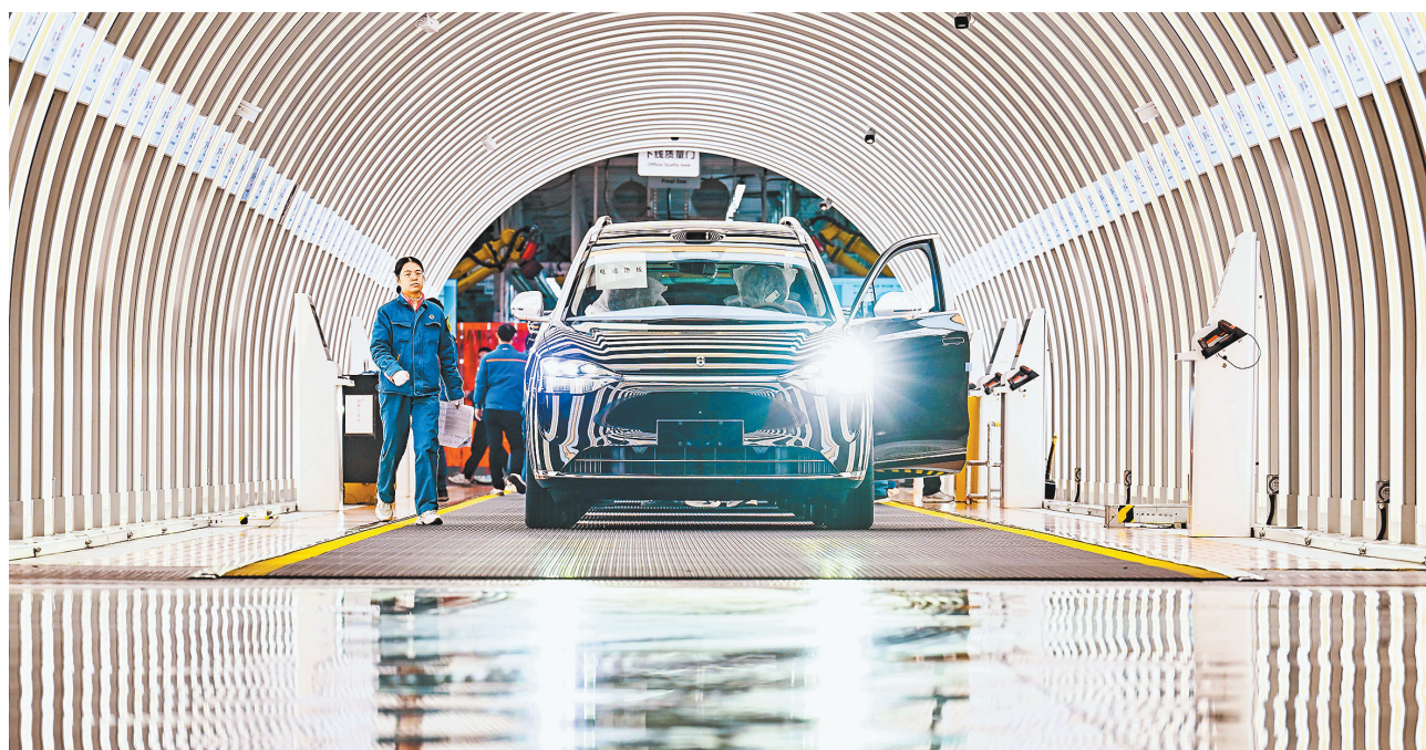
2月21日,位于两江新区龙盛新城的赛力斯汽车超级工厂,工作人员在下线质量门处对问界M9进行外观、内饰等检查。 记者 张锦辉 摄/视觉重庆
