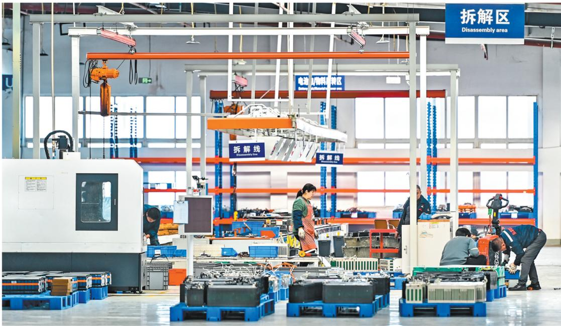
二月二十八日,潼南区汽车回收利用产业园,重庆弘喜锂电能源有限公司车间,工作人员在进行新能源汽车的电池拆解。
