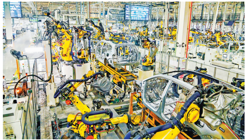
在位于沙坪坝区的赛力斯汽车凤凰智慧工厂焊装车间，自动化机械手臂正在进行焊接等工作。 特约摄影 孙凯芳/视觉重庆
