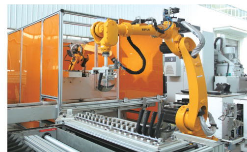
重庆利锋五金有限公司智能化生产车间里，全自动机器人正在对镰刀进行打磨
