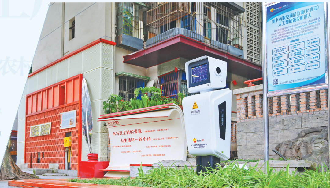
▲2024年12月17日,九龙坡区谢家湾街道劳动二村,外表可爱的化粪池监测机器人静静伫立在道路旁。 记者 李雨恒 摄/视觉重庆
