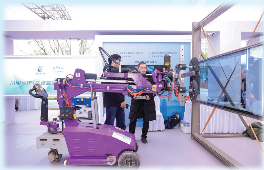
第二届“中国建造·慧享未来”建筑机器人大会现场智能幕墙安装机器人正在操作
