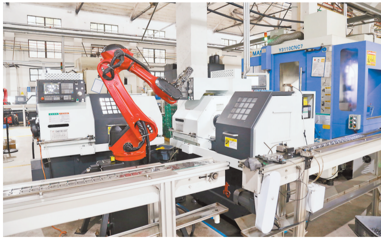
永山机械的车间内，机械手臂在加工摩托车齿轮。（北碚区融媒体中心供图）
