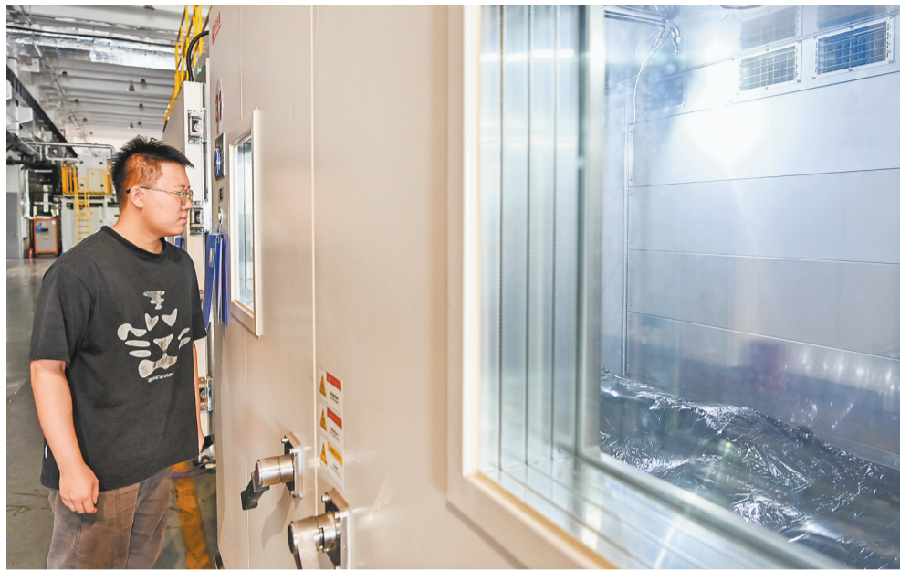
9月3日，中国汽车工程研究院股份有限公司，科研人员正在观察电池包在模拟环境中的工作状态。
