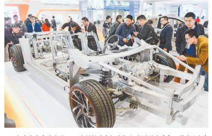
铝合金车身的使用,可以大幅提升车辆的能效、舒适性和寿命。图为观众在 重庆国际博览中心"围观"全铝合金车体框架。(本报资料图片)
