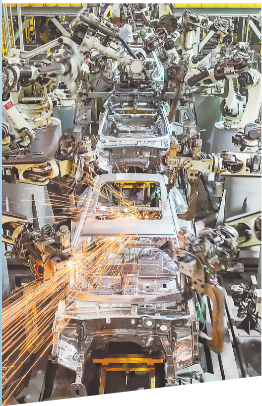
长安汽车焊接车间,智能机械手臂正在进行焊接作业。(资料图片)
