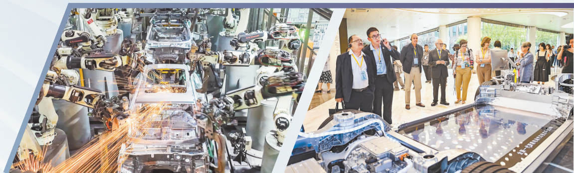
长安汽车两江工厂,智能机械手臂正在进行焊接作业。
