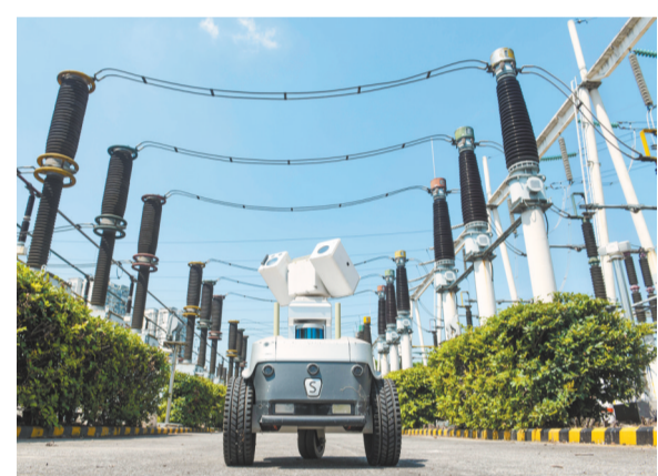
8月7日，渝北区220千伏人和变电站，智能巡检机器人正在作业。 记者 张锦辉 摄/视觉重庆
