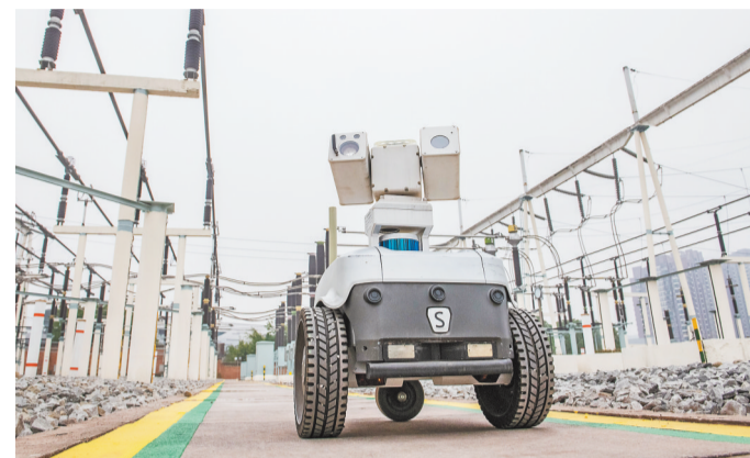
在位于两江新区的220千伏大竹林变电站，巡检机器人正在例行巡视、表计抄录和测温。(摄于2023年1月22日) 记者 张锦辉 摄/视觉重庆
