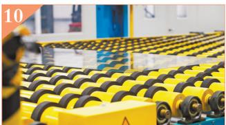
▲透明纳米微晶玻璃生产线。
