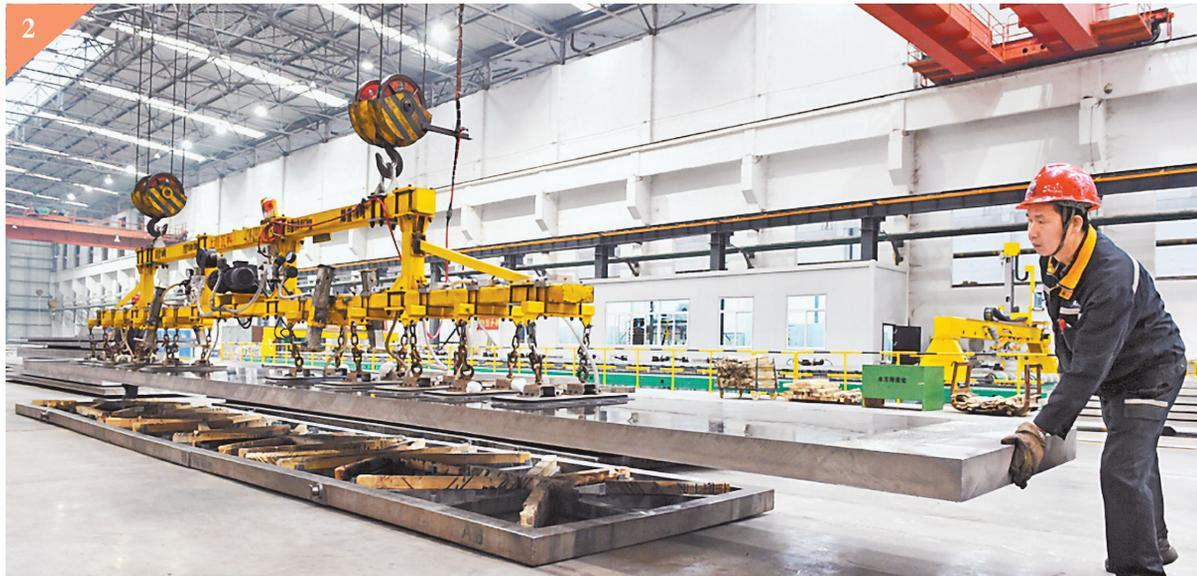
工人正在7050铝合金顶拉伸厚板生产线上作业。
