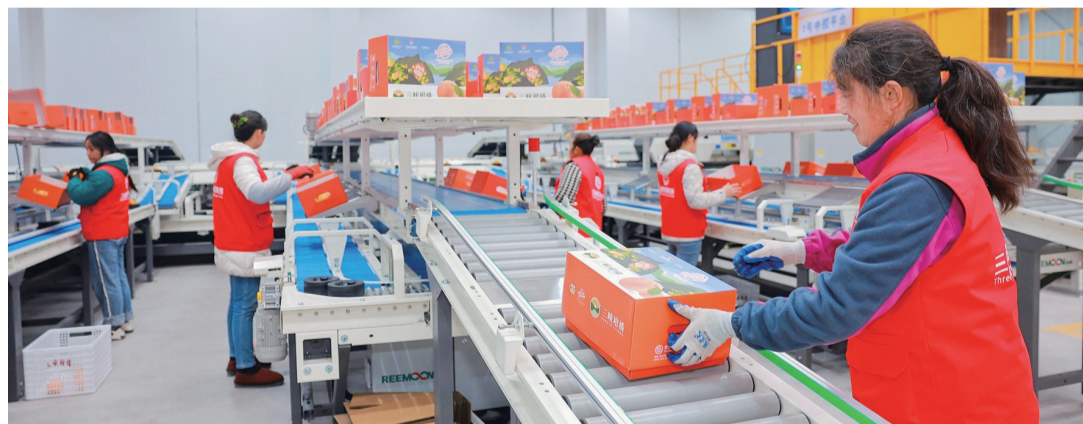
市供销合作社三峡柑橘集团忠县鲜果集散处理基地呵护式双通道分选线
