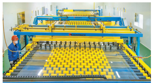
▲重庆鑫景特种玻璃有限公司,工作人员在冷端车间观测玻璃切割作业。这家渝企造出了国产大飞机C919的风挡玻璃原片。
